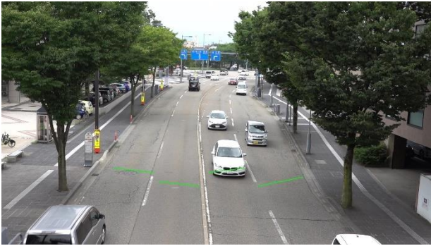
図1 高フレームレートカメラで取得した画像と交流計測のために設定した計測ライン（緑）
