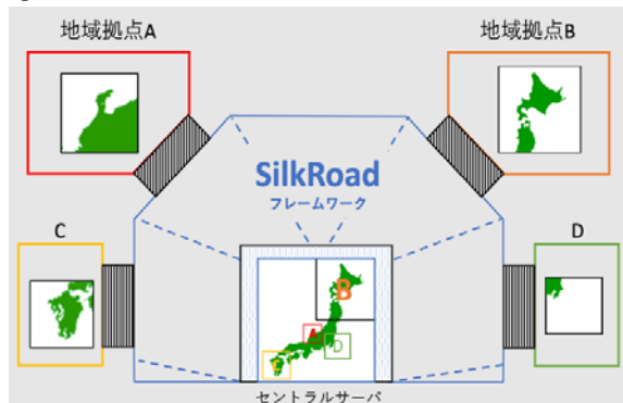
図1. 分散協調シミュレーションの拠点毎の担当計算領域の配置例(2階層の例)
