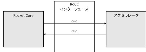
図 1 RoCC を介した Rocket Core ・ アクセラレータ間接続の概略
