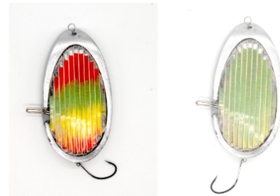
図 5 自作したレンチキュラーレンズによる試作 (左:縞模様, 右:単色(緑))
