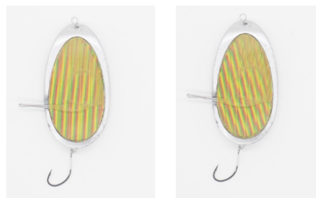
図 6 市販のレンチキュラーレンズを用いた試作 (左:縦縞模様, 右:斜め縞模様)
