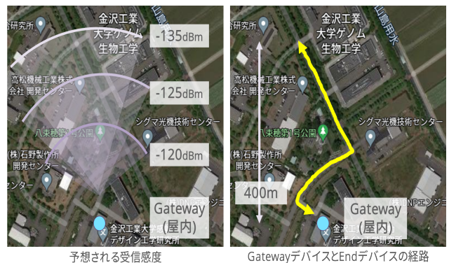
図 16 移動体通信における提案システムの評価方法
