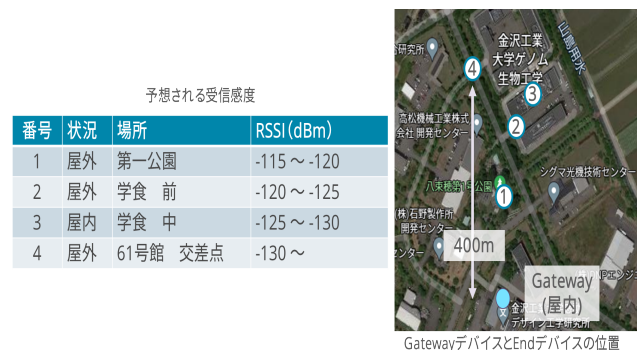
図 17 時分割多元接続通信における提案システムの評価方法 Fig. 17 Evaluation method for proposed systems in time division multiple access communication.
