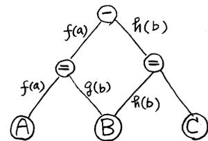
**擬似レコード**。比較相手なしの理由でシステム内に滞留するレコードの数を減少するために, 擬似レコードの考えがある。比較値の意味で  $A \cap B = \phi$  とすると, 右図中CはE $\cap$ Fまでレコードは到着しないので,
