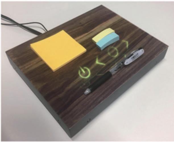
図5 ステルス空中インターフェースの実機
