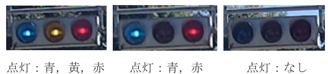
点灯：青, 黄, 赤 点灯：青, 赤 点灯：なし 図6 車両用信号機拡張した色パターン Fig. 6 Expanded color patterns for vehicle traffic light.
