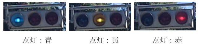
点灯：青 点灯：黄 点灯：赤 図5 車両用信号機の一般的な色パターン Fig. 5 General color patterns for vehicle traffic light.
