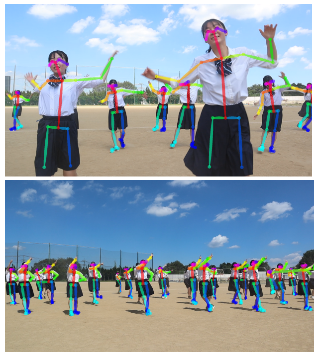
図12 ズーム設定検出のための骨格位置情報検出例 上段：寄りの場合 下段：引きの場合
