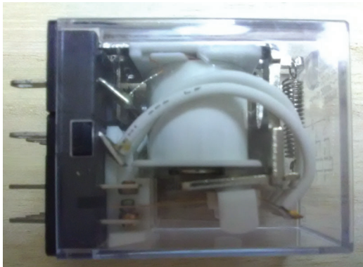
図 2 DC12V 4 回路 2 接点リレー
