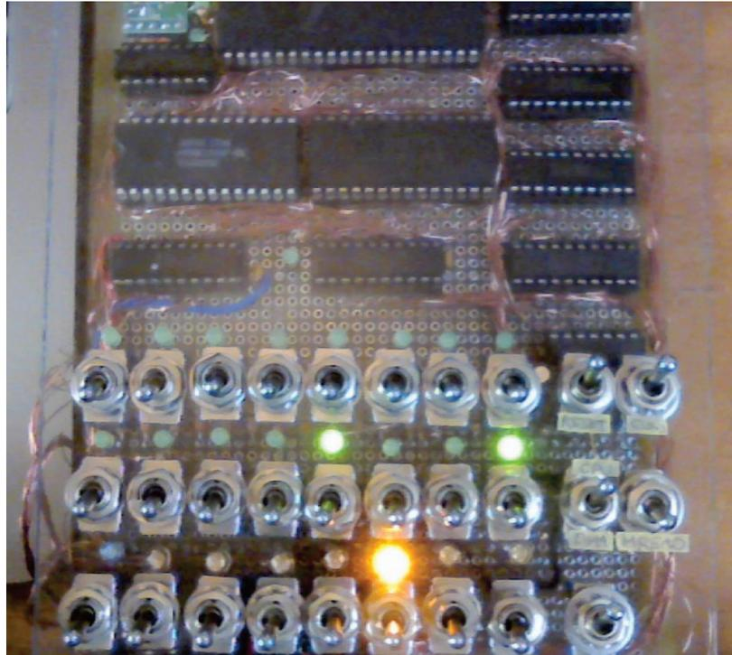
図 2 実際に作成した Z80 マイクロコンピュータ.
