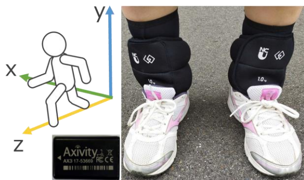
図1 使用した加速度センサの軸およびセンサ・重錘の装着位置
