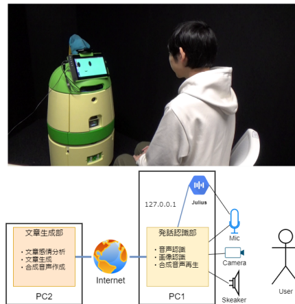
図 1: 音声対話システム。上：実装環境，下：構成図。
