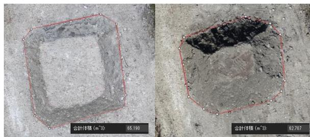
図 4 施工前後の盛土体積の算出
