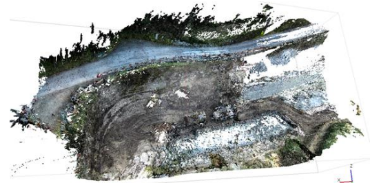
図5 ヘルメットカメラ映像から作成した三次元点群データ
