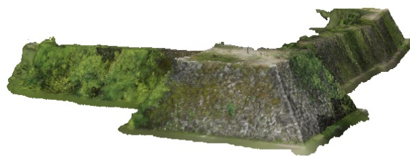
図1. 天守台周辺の石垣の計測結果
