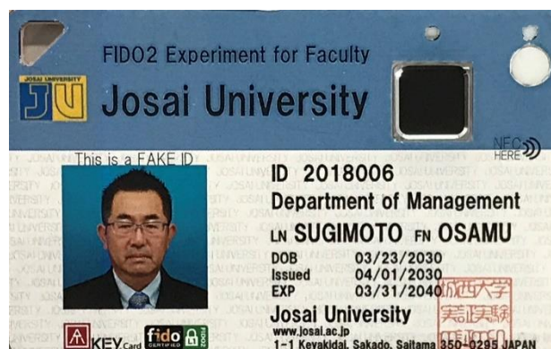
図 1 身分証型 FIDO2 セキュリティーキー (シングルデバイスで多要素認証:所持+生体を実現)
