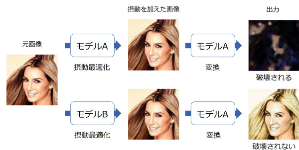
図1 摂動転移性の概要図。モデル A に対して最適化された摂動はモデル A の出力を破壊できるが、モデル B に対して最適化された摂動ではモデル A の出力を破壊できない。
