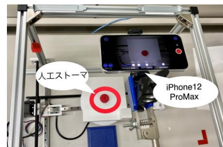
図3: カメラの設置例。中央右上にあるのが iPhone12 ProMax、中央左下にある赤い丸い物体が人工ストーマ
