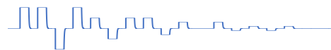
図2 アナログコンパレータの反転入力に与える波形（振幅が減衰するランダムパルス）
