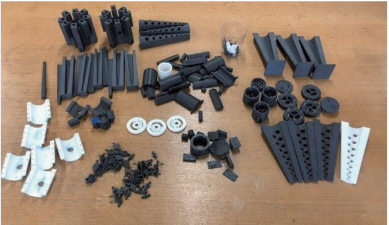
図-5 タコ型ロボット製作のために作った型の一部
