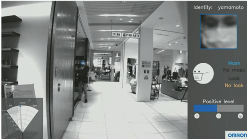
図6 バックパックの画像認識技術で前方知人の存在・状態を認識している様子
