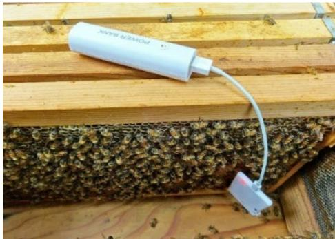
図 9 養蜂箱内に設置した試作温湿度センサ
