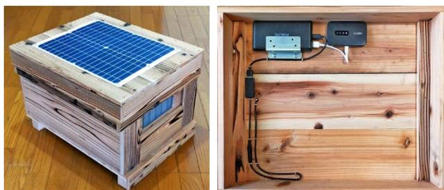
図 13 ソーラーパネルとモバイルバッテリーによるルータの駆動
