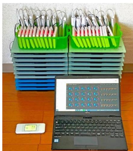
図 15 ルータへの 40 台のセンサ接続
