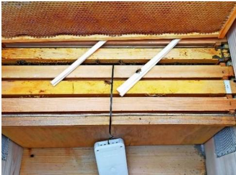
図 10 養蜂箱内に設置した新温湿度センサモジュール
