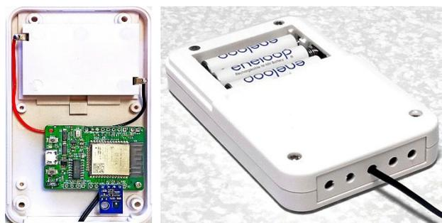
図 7 電池ボックスに組み込んだ温湿度測定用養蜂センサ
