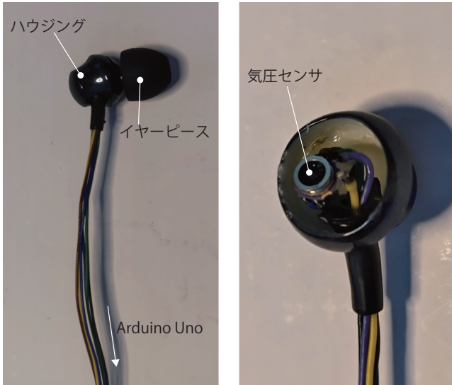
図 2 実装した気圧センサ搭載カナル型イヤホン
