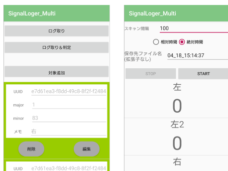
図 4 BLE ビーコンの受信電波強度を測定する Android アプリ
