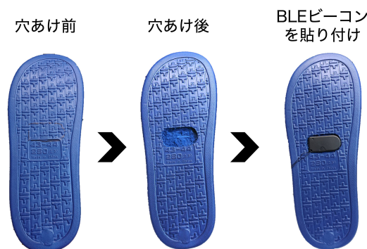
図3 履物への BLE ビーコンの貼り付け
