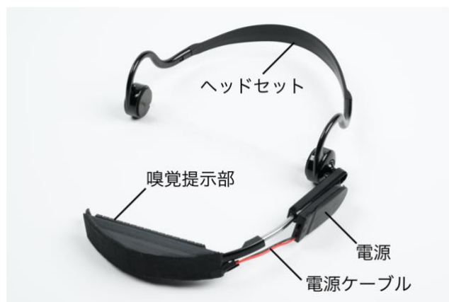
図2 提案システムの嗅覚提示装置
