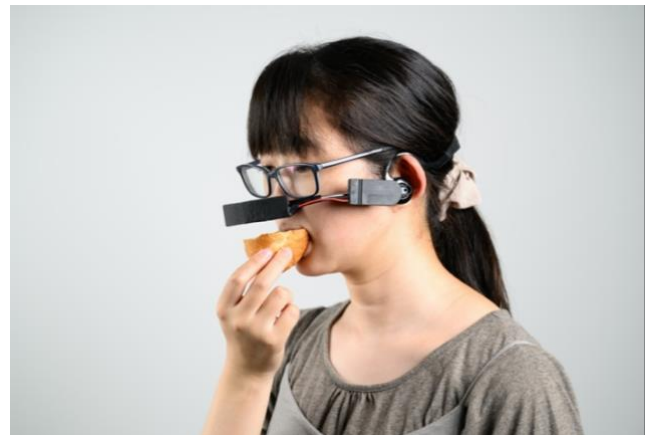
図1 味覚及び嗅覚提示システムを用いたガーリックトーストを食べている様子
