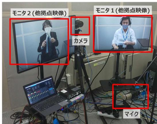
図 5 各ユーザ拠点 (防音室) の機器配備の様子
