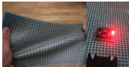
図1 伸縮性を有する二次元通信シート (左) とその使用例 (右)
