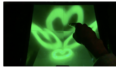
図 2 提案システムで空中ミスト映像を描画している様子
