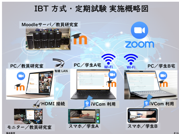
図 3 試験システムの概略図（Zoom, Moodle, ノート PC, iVCam, スマホなどが含まれる）
