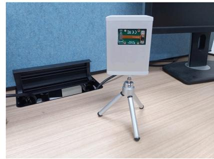
図 2 センサデバイス (Hitonavi-μ) の外観
