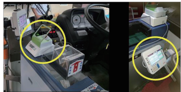
■図-5(b) 降車時のQRコード決済端末および運転手用端末
