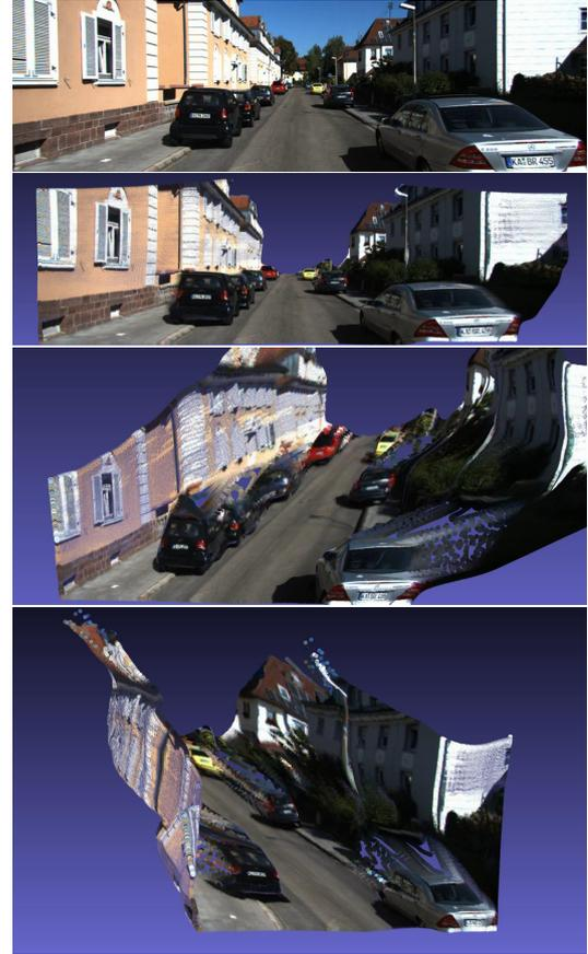
図3 自己位置推定で推定で得られる疎な環境マップと深度推定で得られる密な相対深度マップを組み合わせると画像全体の密な深度マップが得られる。カメラからは見えない車の裏などは情報を復元できない。
