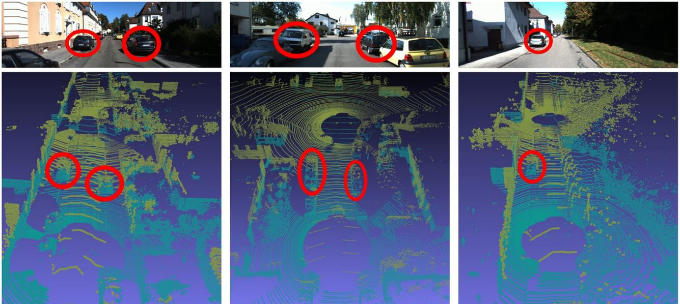
図5 あるフレームとその5秒後のフレームのLiDAR点をそれぞれ水色，黄緑色で投影する。壁や停止中の車など固定された物体上に点が重なっていることが分かる。このことから，本手法で求められるカメラの外部パラメータは5秒間の間では正しく推定できる。
