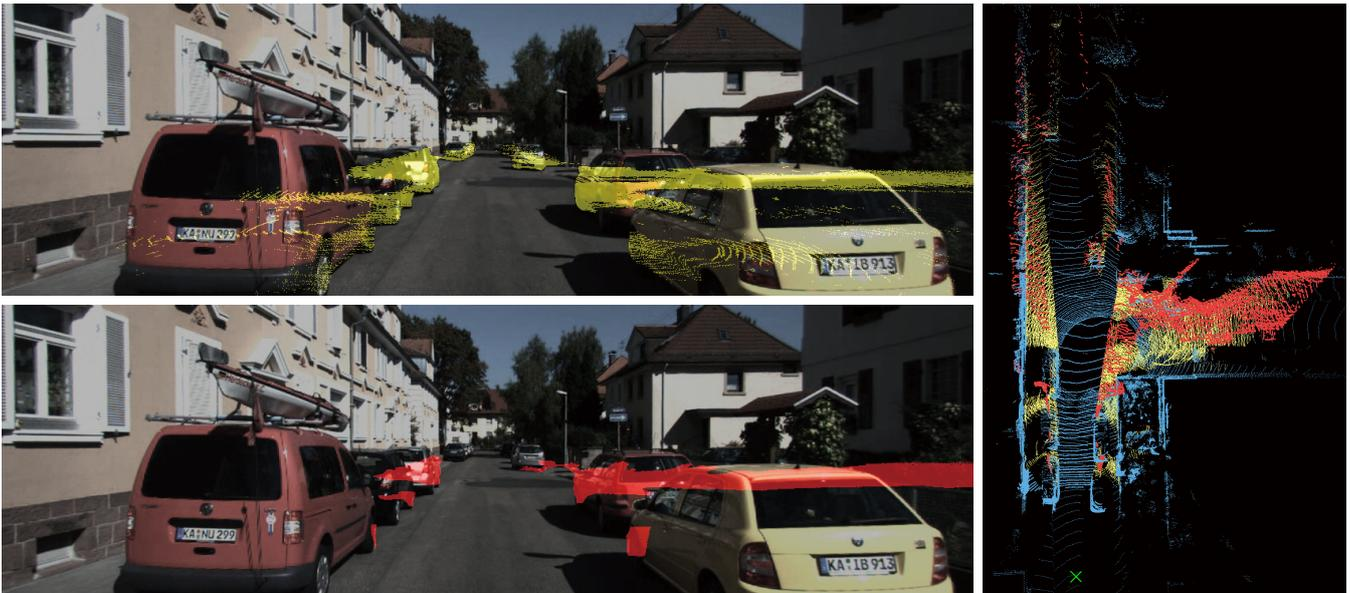
図6 [左上] 元画像に対し LiDAR で得られる死角を投影したもの。LiDAR で得られる死角は疎である。[左下] 提案手法により得られる死角。本手法で得られる死角は密である。[右] LiDAR 点群全体 (水色), LiDAR で得られる死角 (黄色), 本手法で得られる死角 (赤色) を三次元的に投影したもの。緑色のバツ印は視点の位置を表す。
