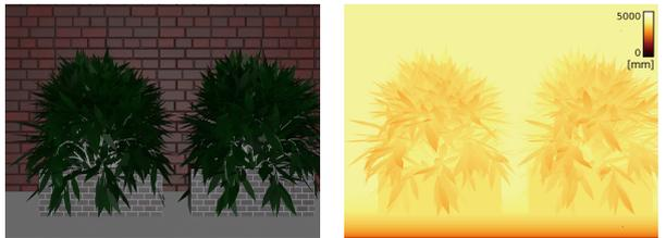
(c) 深度の変動が大きい対象の RGB 画像 (d) 深度の変動が大きい対象の深度マップ
