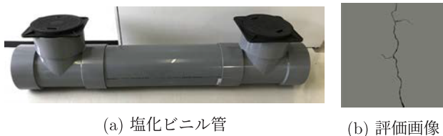
図 17 模擬実験環境 ((b) の傷: 最大幅 5 mm, 最大長 150 mm)
