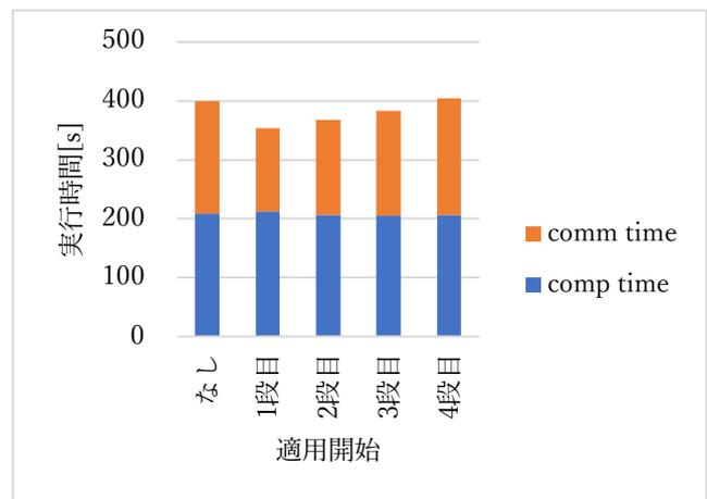
図 4 袖領域を深く交換する方法を適用した際の実行時間 (8 ノード)
