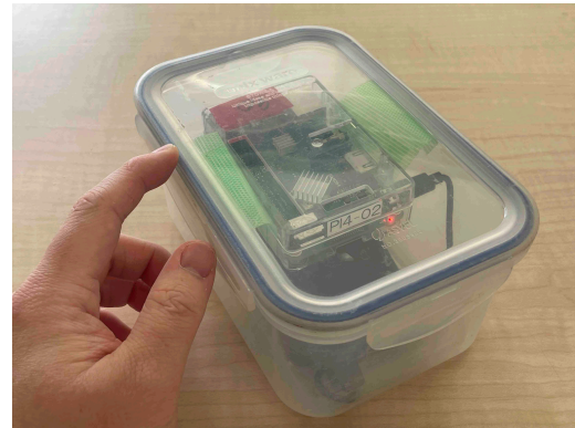
図 8 実験に使用した送信端末（浮流ノード）
