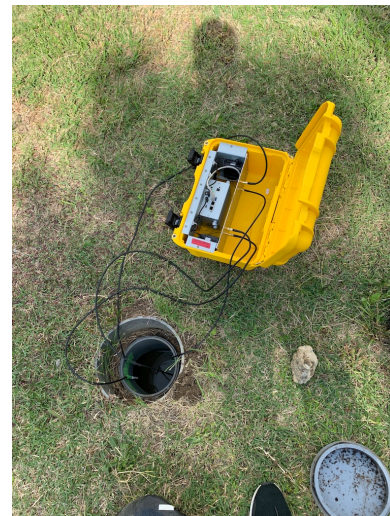
図 9 受信側端末 (AP) とアンテナ配置
