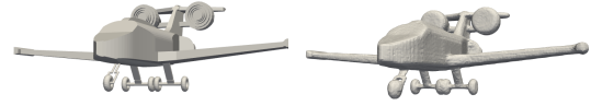
図3 正解メッシュ例。左：元メッシュ。右：作成した水密メッシュ。 Fig. 3 An example of the ground truth mesh. Left: The original mesh. Right: the created watertight mesh.
