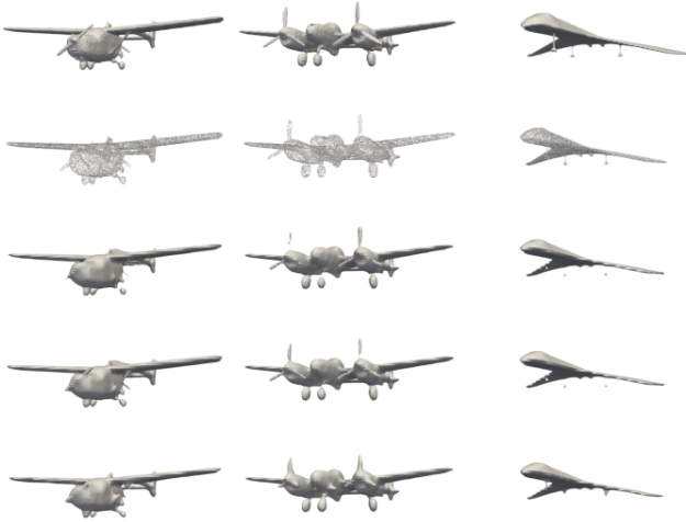
図 6 定性比較：悪い例. 上から, 元メッシュ, 学習点群, B(L_{\text{base}}) , FT(L_{\text{base}}) , FT(L_{\text{base}}, L_{\text{conn}}, L_{\text{ps}}) .
