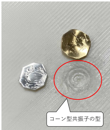
図 5: コーン型共振子と 3D プリンタで製作した共振子成形用の型
