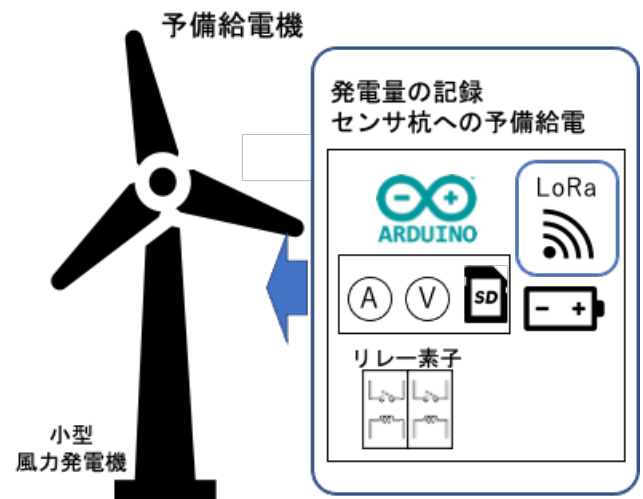
図 2 予備給電機のシステム簡略図
