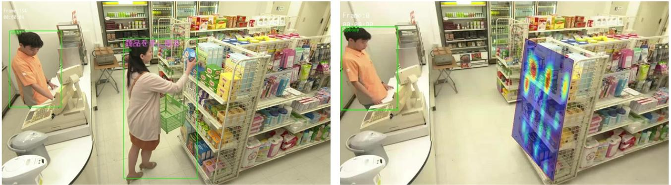
図 1 手伸ばし行動検知と棚のリーチ分析の例。左図は人が商品棚に手を伸ばしているのを行動分析により検知した結果を示しており、右図は手伸ばし行動が検出された商品棚のヒートマップを示している。
