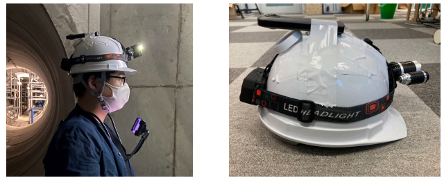
図 14 実験用具の取り付け位置
