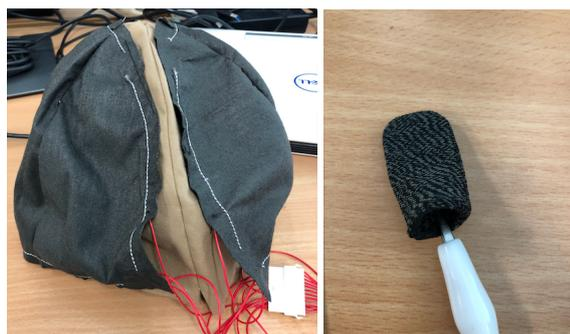
図2 帽子型タッチセンサのプロトタイプ及び導電性指サック
