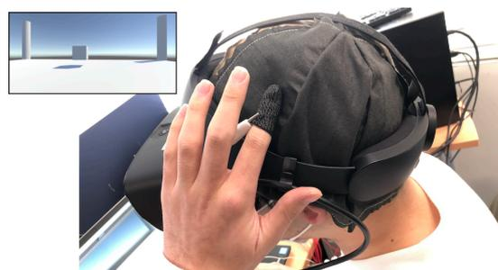
図4 帽子型タッチデバイス及びHMDを装着している様子とHMDに表示されるUnityシーン(左上)
