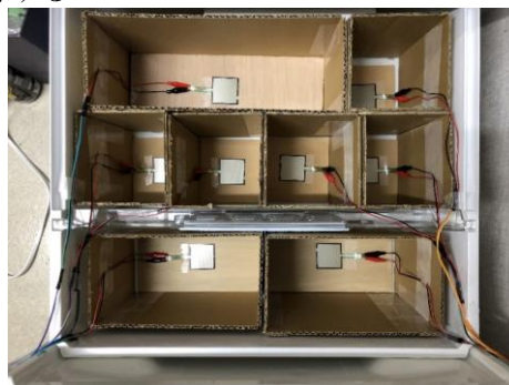
図 2 8部屋に分割した野菜室と感圧センサ
