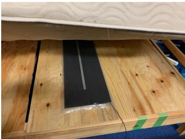
図 2 圧力センサと設置位置
