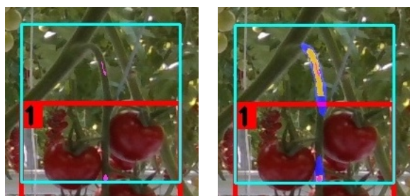
(a) 拡張前 (b) 拡張後 図2 Grab Cut による果柄領域の拡張
