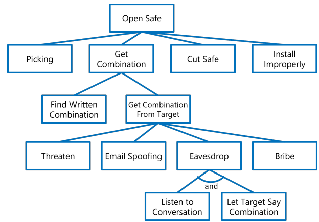
図 5 金庫が開けられる場合の Attack tree の例 (参照: Practical IoT security lecture materials)
