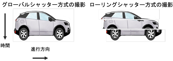
図 1 シャッターの違いによるカメラ撮像イメージ Fig. 1 Image of difference by shutter
