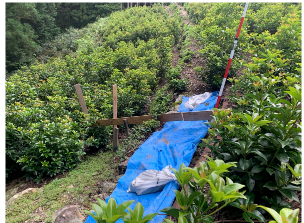
図3 移動変位を計測する木板センサ
