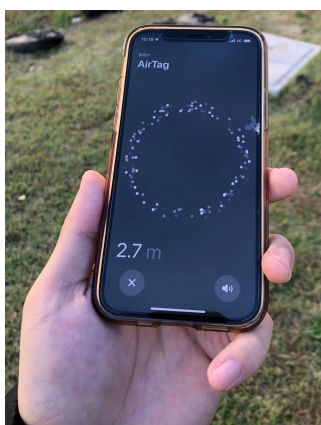
図 6 ハンドホール内に投入した端末 (タグとの距離をリアルタイムに表示している)
