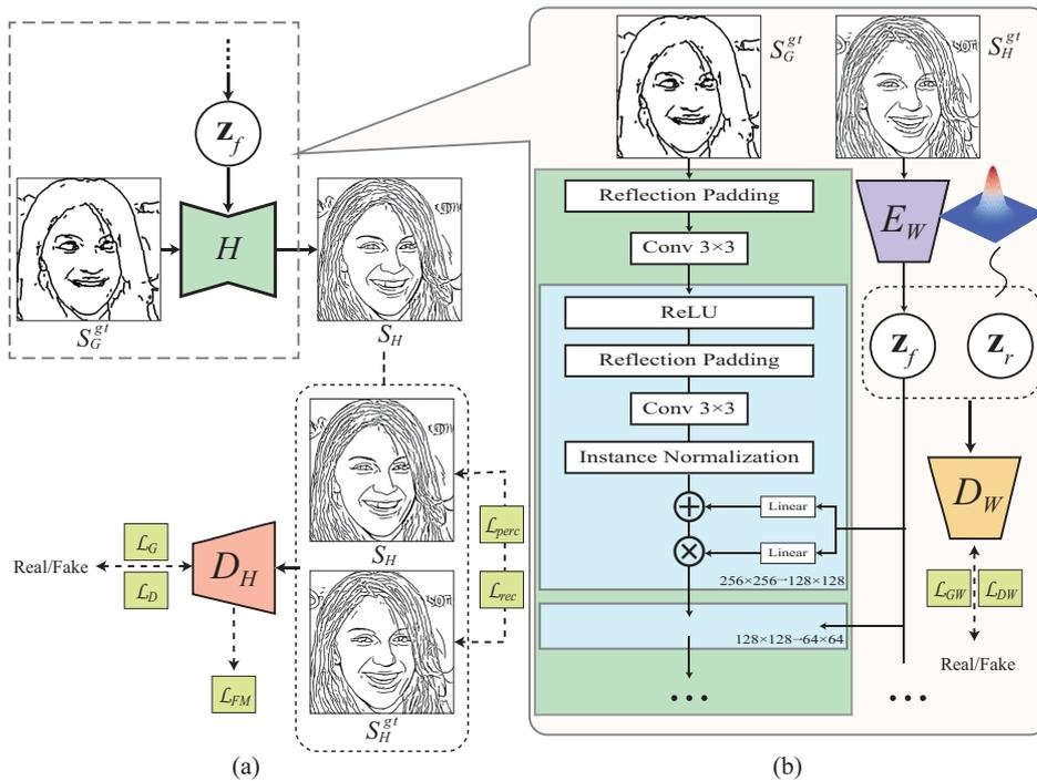
図3 本手法のネットワーク  $H$  の訓練時の概要図。ネットワーク  $F$  については  $\mathcal{L}_{FM}$  を損失関数として用いないこと以外は  $H$  の訓練と同様である。(a) は学習時の全体像を表しており、(a) の一部の詳細を (b) に示す。
